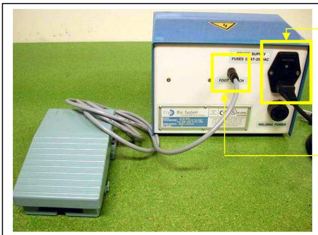
⇒ Connecter le câble secteur « Cb1 » à l'embase du filtre d'entrée « U0 » identifier par : **POWER SUPPLY**
