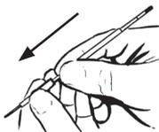
1. Insérer directement et fermement l'extrémité de la paillette CBS™ Haute Sécurité destinée à contenir l'échantillon biologique dans l'embout de remplissage. Un clic peut être perçu. Le capillaire central entre dans la paillette sans en toucher la surface intérieure. Vérifier la bonne connexion en appliquant une légère force de retrait sur l'embout de remplissage qui ne doit pas bouger.
